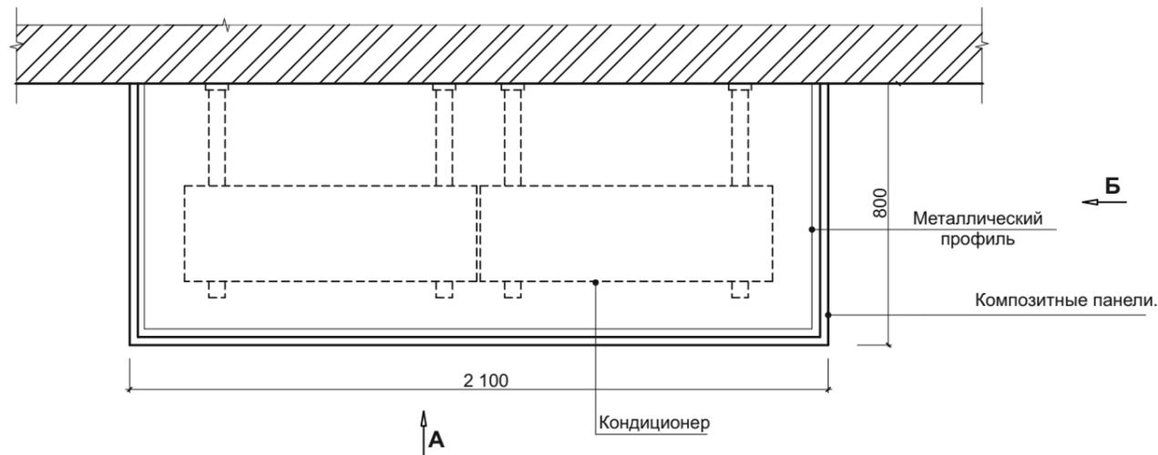
1. Материал экрана - Композитные панели. . Цвет: Хром.
